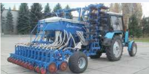
Управление перевода из транспортного положения посредством гидросистемы в рабочее и наоборот, без сложных физических усилий оператора
