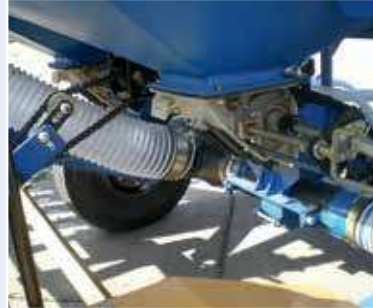
Зерновой высевальной аппарат вакуумного типа
