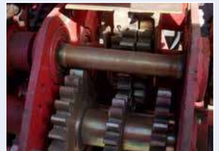
Шестеренчатый редуктор привода высевальных аппаратов
