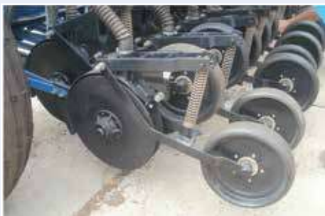
Единая конструкция узла позволяет настраивать величину давления и диапазон хода прикатывающего катка с интервалом в 1 см
