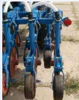
Одновременное прикатывание почвы сразу после заглабления семян
