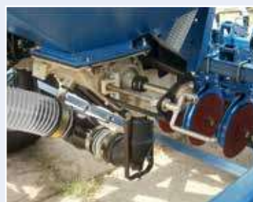
Зерновой высевальной аппарат вакуумного типа
