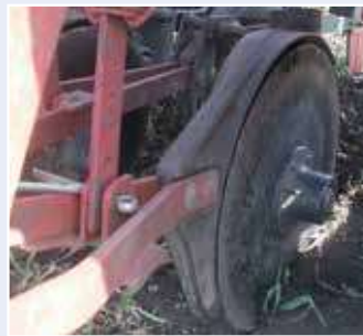
Рабочие органы – двухдисковый сошник и наральник
