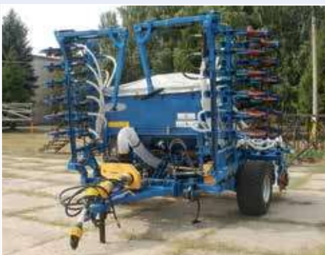
Специальная навеска облегчает крепление устройства к навесным элементам трактора
