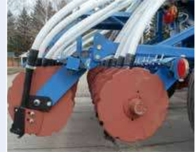
Рабочие органы – однодисковые сошники с радиальными вырезами для возможности работы на не очень чистых или влажных землях
