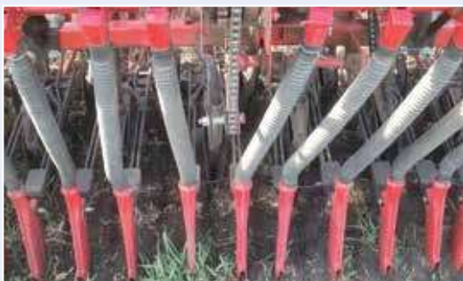
Через наральниковые сошники высеваются мелкие сыпучие семена трав, а также осуществляется высеv сыпучих семян трав под покров зерновых
