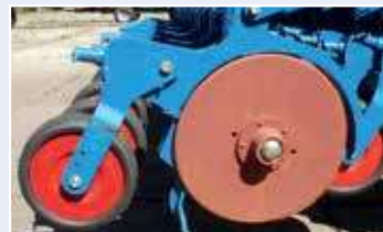
Рабочие органы – двухдисковые сошники и прикатывающие колеса
